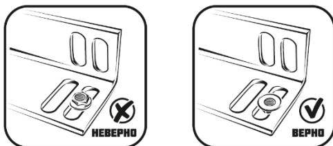
3. Затяните винты крепления электромагнита при помощи шестигранного ключа из монтажного комплекта.
